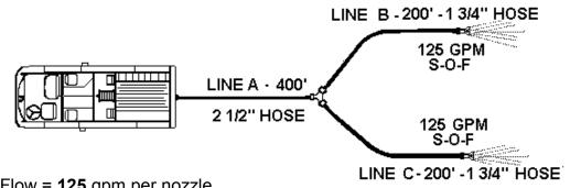
Step One: Flow = 125 gpm per nozzle
