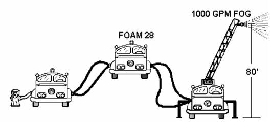
ALLOW 25 PSI LOSS FOR LADDER SYSTEM LOSS (LSL)\*\*\*
