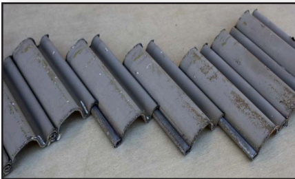
Figure 21-31 Rolling Steel Door (Interlocking Slats)
